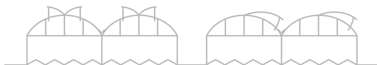
m 01, ventilación doble
